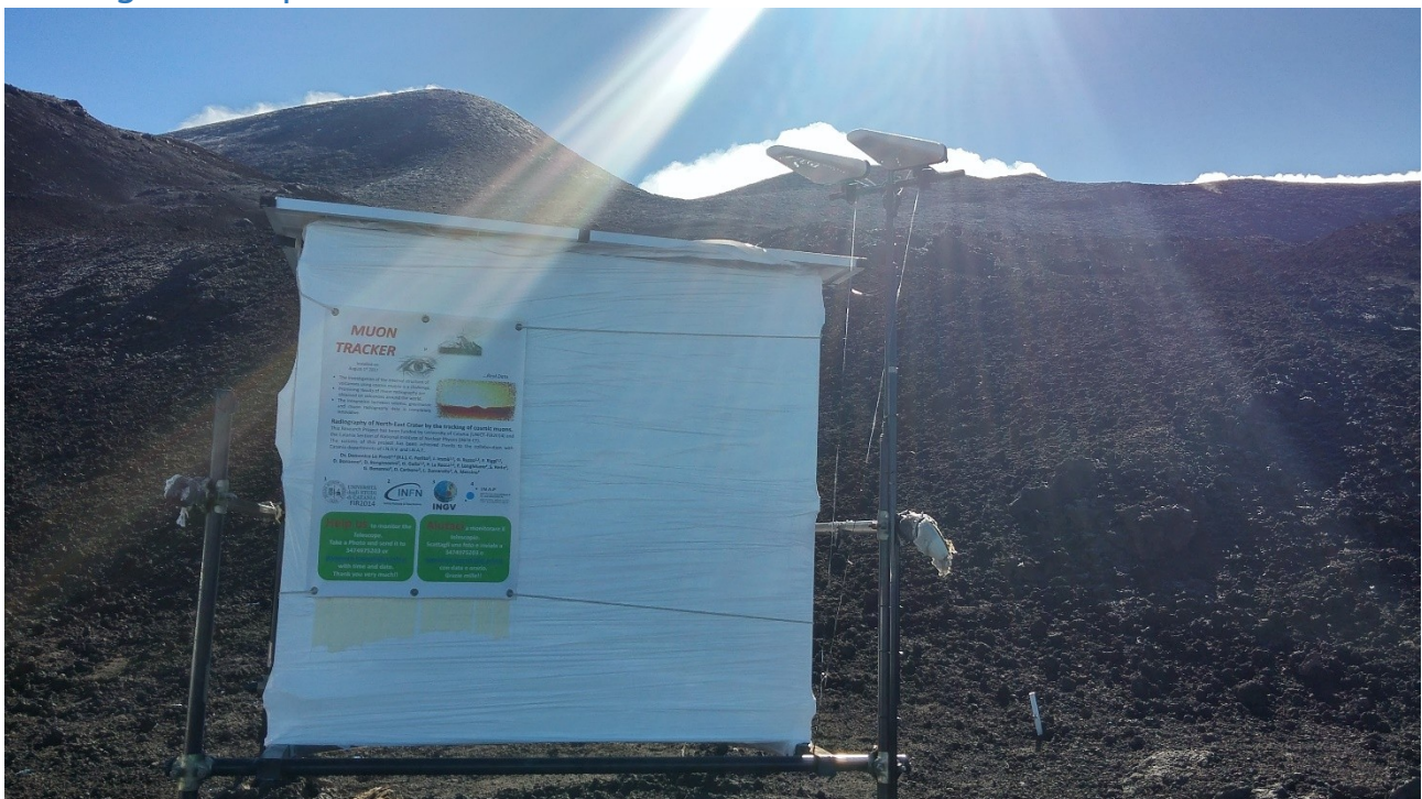
Figure 1 Foto del Telescopio MEV nel sito di misura a 3100 m s.l.m. sulle pendici del cratere di Nord-Est del vulcano Etna.
